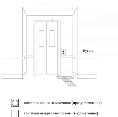
Фиг. 60. Свободно пространство пред достъпен асансьор
