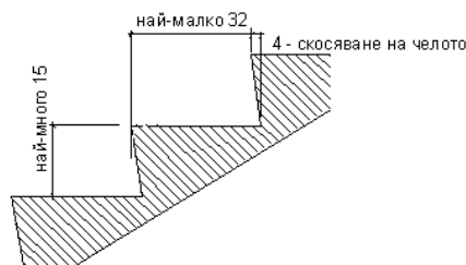
Фиг. 21. Размери на стъпала
